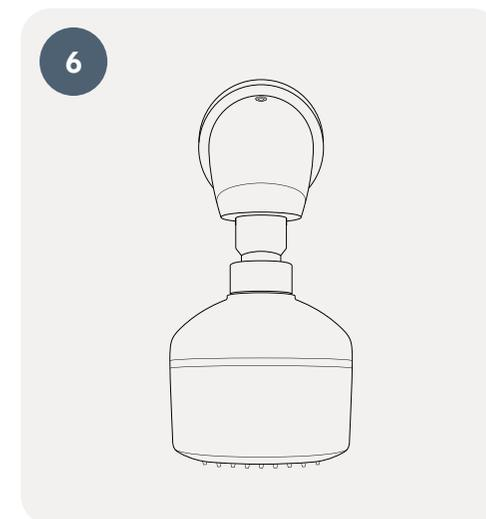
Raccorder le T-safe Filtre Douche Murale Easy-Fix (02-092031) au bras de douche à l'aide du raccord fileté 1/2 ".
