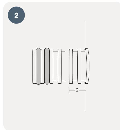
Couper le raccord de tuyauterie, en laissant deux encoches apparentes sur le mur. Dévisser la tuyauterie, appliquer un matériau d'étanchéité approprié pour éviter les fuites, puis la revisser solidement en place.
