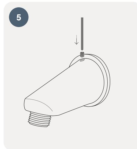
Befestigen Sie den Duscharm an der Basisplatte und sichern Sie ihn mit der Gewindschraube.
