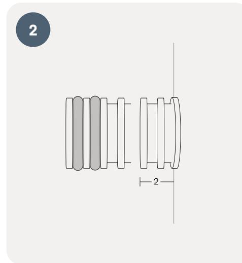
Schneiden Sie die Rohrleitungsverbindung ab und lassen Sie zwei Vertiefungen an der Wand frei. Schrauben Sie die Rohrleitungen ab, tragen Sie ein geeignetes Dichtungsmaterial auf, um Leckagen zu vermeiden, und schrauben Sie sie dann wieder fest.
