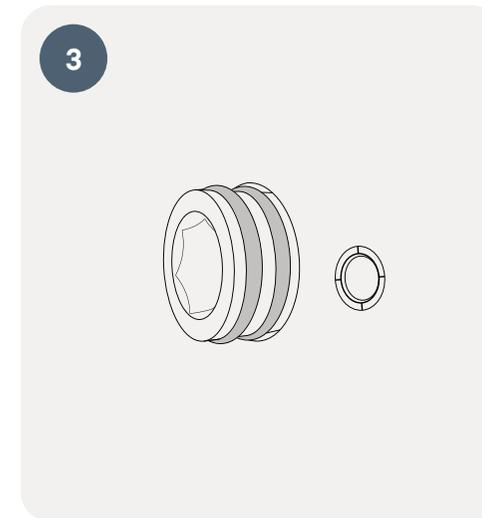
Platzieren Sie einen O-Ring auf jeder Vertiefung (zwei insgesamt).
