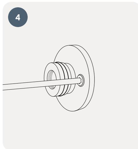
Befestigen Sie die Basisplatte mit den mitgelieferten Schrauben an der Wand.
