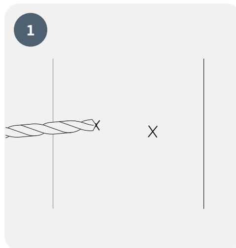
Montage der Basis: Markieren und bohren Sie zwei Löcher mit einem 8-mm-Bohrer.
