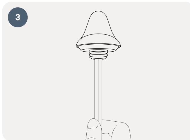
Setzen Sie den anderen Teil des Adapters ein und schrauben Sie ihn von Hand locker ein. Ziehen Sie ihn dann mit einem sauberen 12-mm-Inbusschlüssel fest.
