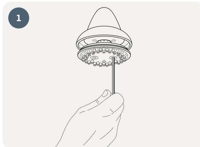
Entfernen Sie die Sprühplatte und den O-Ring mit einem 3-mm-Inbusschlüssel vom Horne-Duschkopf. Bewahren Sie sowohl die Sprühplatte als auch den O-Ring an einem sicheren Ort auf, damit sie bei Bedarf später wieder installiert werden können.
