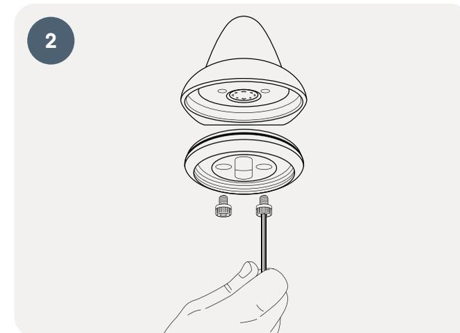
Schrauben Sie die beiden Teile des Adapters (90-001882) von Hand voneinander ab. Setzen Sie den Basisteil in den Horne-Duschkopf ein und befestigen Sie ihn mit den Original-Schrauben des Duschkopfes und einem sauberen 3-mm-Inbusschlüssel.
