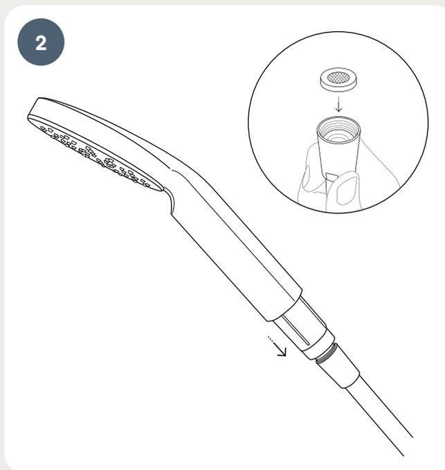
Retirer la douchette du filtre. Remplacer le filtre usagé par un nouveau ou installer une fausse cartouche si vous souhaitez utiliser de l'eau non filtrée.
