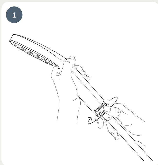
Dévisser la bague de verrouillage au bas du filtre de douche en la faisant tourner manuellement dans le sens inverse des aiguilles d'une montre.
