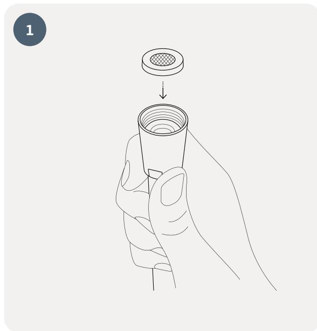
Retirer l'ancien joint du tuyau de douche et insérer le nouveau joint fourni dans l'emballage.
