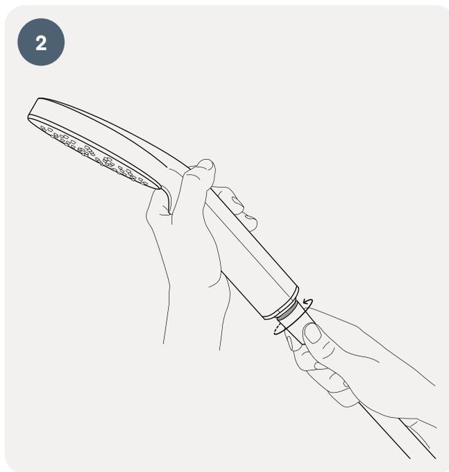
Serrer manuellement le filtre de douche sur le tuyau.
