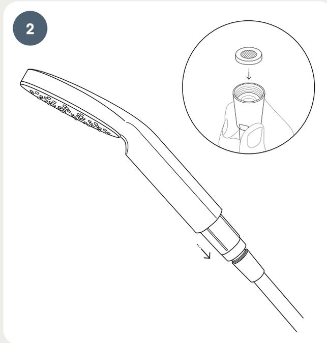
Nehmen Sie anschließend den Duschgriff vom Filter ab. Ersetzen Sie den gebrauchten Filter durch einen neuen oder setzen Sie eine Blindpatrone ein, wenn Sie ungefiltertes Wasser wünschen.
