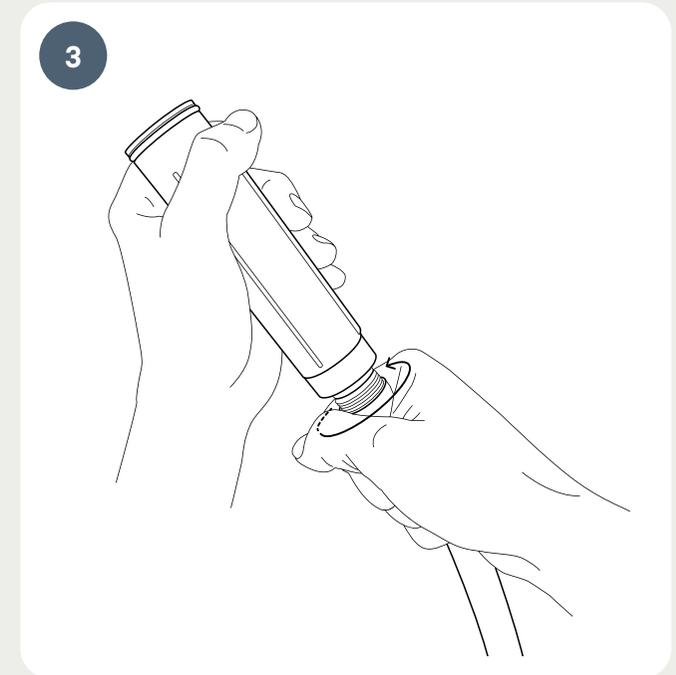
Stellen Sie sicher, dass der Filter fest mit dem Schlauch verbunden ist, um zu verhindern, dass Wasser ausläuft.
