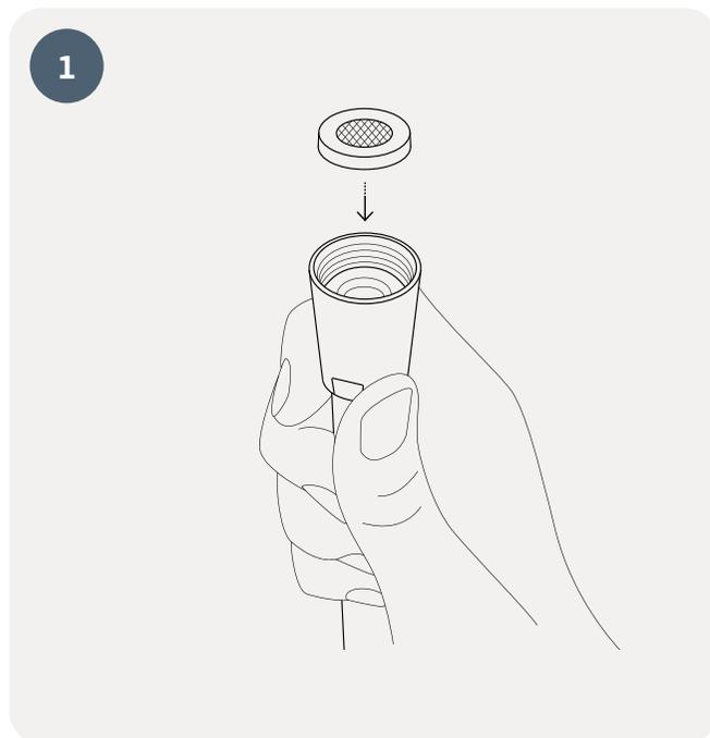
Entfernen Sie die alte Dichtung vom Duschschlauch und ersetzen Sie sie durch die neue Dichtung aus der Verpackung.
