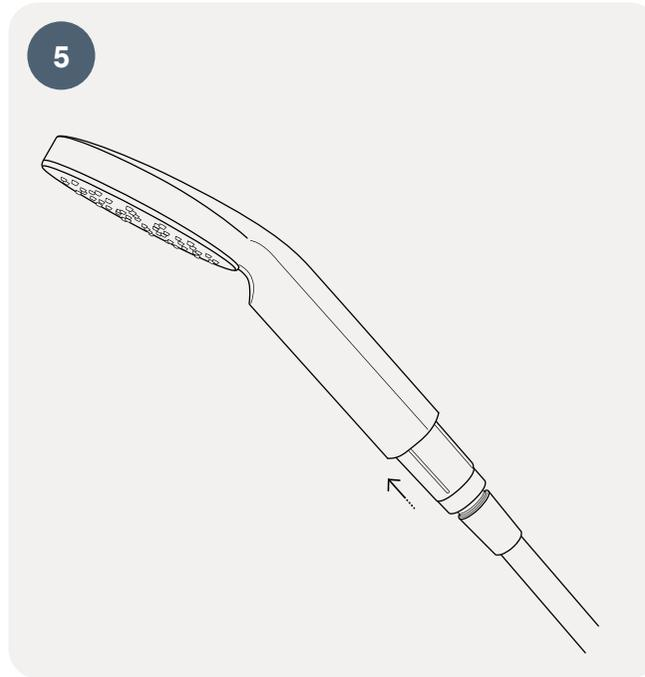
Schieben Sie den Filter anschließend wieder in den Duschgriff.
