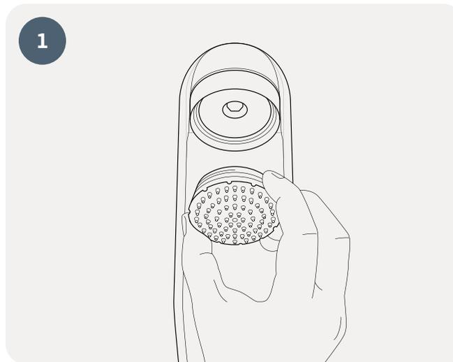
Entfernen Sie die Sprühplatte und den Durchflussbegrenzer von der RADA S.PA 1 Duschblende. Bewahren Sie diese Teile an einem sicheren Ort auf, damit sie später bei Bedarf wieder eingebaut werden können.
