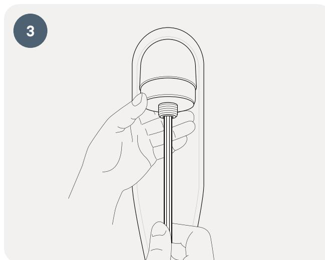
Setzen Sie den Adapteranschluss ein und ziehen Sie ihn mit einem Innensechskantschlüssel HEX 10 fest.
