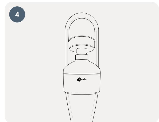
Schließen Sie den T-safe Easy-Fix Wandduschfilter (02-092031) an das 1/2"-Gewinde an.
