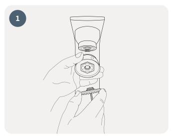
Entfernen Sie die Sprühplatte vom Presto Brausekopf, indem Sie die mittlere Innensechskantschraube lösen. Bewahren Sie diese Teile an einem sicheren Ort auf, damit sie später bei Bedarf wieder eingebaut werden können.
