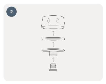
Setzen Sie die transparente Silikondichtung, den Adapter und die folgende Innensechskantschraube in den Presto Brausekopfring ein.
