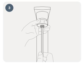
Schieben Sie den Adapter und den Brausekopfring in Position und befestigen Sie ihn mit der hohlen Mittelschraube mit einem sauberen 8-mm-Sechskantschlüssel. Ziehen Sie sie fest an.
