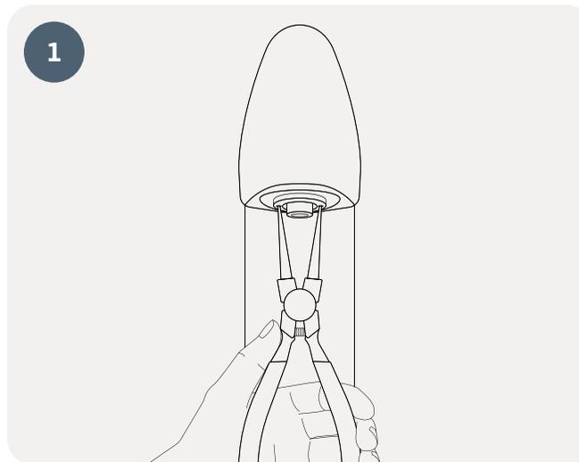
Entfernen Sie die Sprühdüse mit einer Sicherungsringzange von der Delabie Duschblende bzw. dem Delabie Brausekopf. Bewahren Sie die Sprühdüse an einem sicheren Ort auf, damit sie später bei Bedarf wieder eingebaut werden kann.
