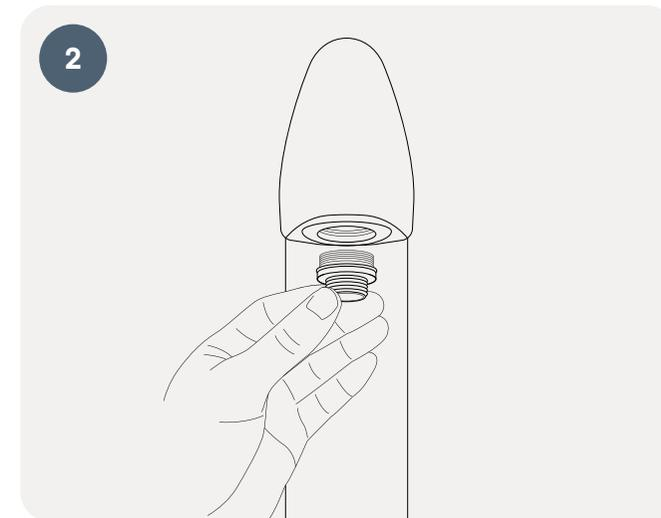
Stecken Sie den Adapter in die Delabie Duschblende bzw. den Delabie Brausekopf, indem Sie ihn von Hand locker einschrauben.
