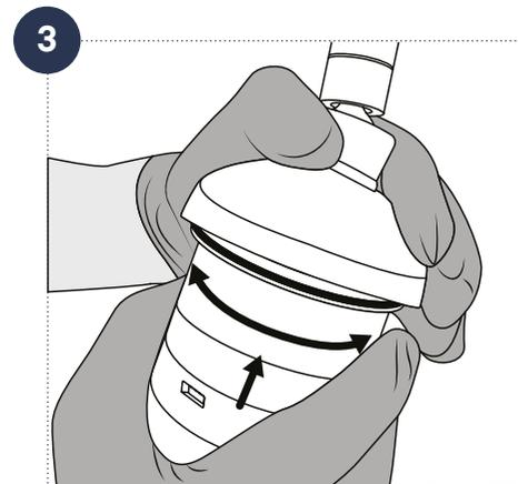
4. Placez le couvercle sur le corps. Fixez le couvercle au corps en tournant la bague de verrouillage dans le sens antihoraire.
