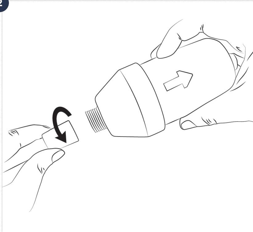
4. Fest den andre slangen til filteret. Etter at filteret er installert, må det påses at slangene ikke er vridd, for å unngå redusert vannstrøm. Når filteret er installert, må det påses at slangene sitter godt, slik at skade på filteret unngås.
